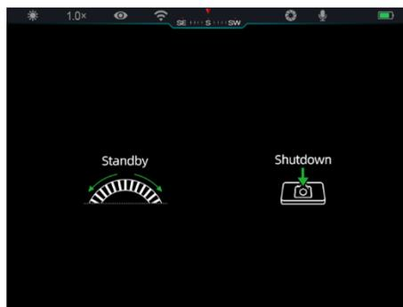
(9), чтобы сначала завершить калибровку фона. Затем вы можете открыть крышку (9), чтобы вернуться на главный экран, или перевести устройство в режим ожидания, повернув **контроллер (3)**, или выключить его, нажав **кнопку камеры (4)**, согласно инструкциям на экране.
